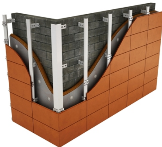
Вертикальная система крепления на основе Т-образного профиля с применением кляммера КТ для плит CN Ceramic
