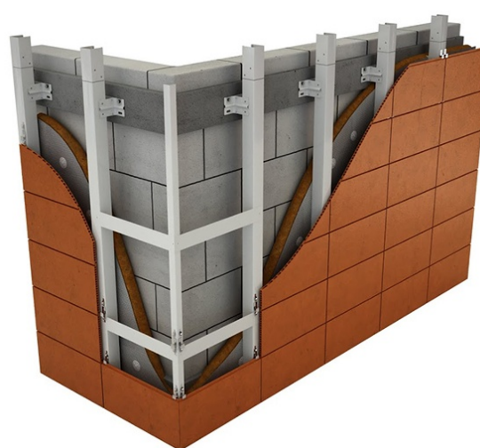
Вертикальная система крепления на основе С-образного профиля
