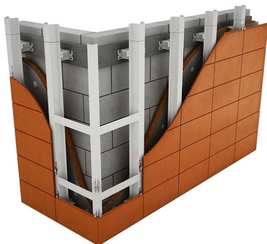
Вертикальная система крепления на основе Т-образного профиля
