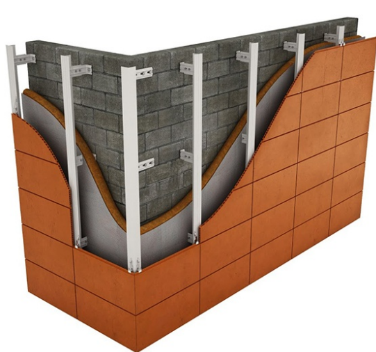
Вертикальная система крепления на основе Т-образного профиля
